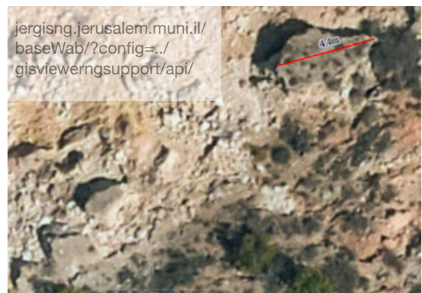
איור 8: מפולות סלעים גדולים. ימין: תצלום אוויר מ-2019. צד ימין תחתון של התמונה מראה פני שטח סדוקים ומופריים קרוב לגובה המקורי לפני מפולת. החלק העליון ושמאלי מראה את המפולת, כולל סלעי ענק. בימין למעלה גוש סלע במשקל משוער של למעלה מ-50 טון שהתנתק והחל את מסלולו למטה. משמאלו ולמטה בצילום סלעים עד גודל מטר מעוקב שנפלו מספר מטרים. מתוך אתר עיריית ירושלים.
